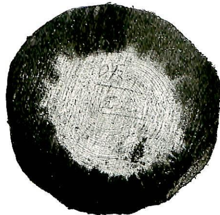
Fig. 3. Snitt av furumast etter neddykning i Bernakré i 6 min.
