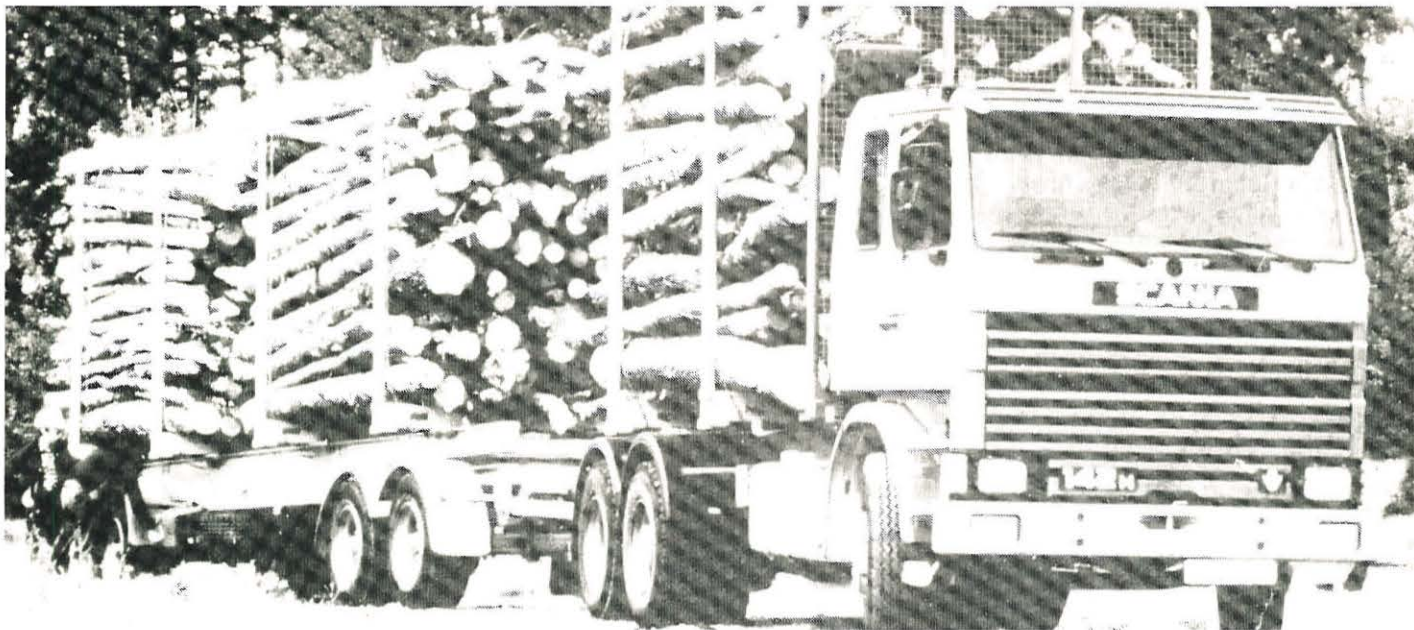
22-meters vogntog med tømmer vil få lavere lasshøyde, samt at vegslitasjen kan bli redusert.
