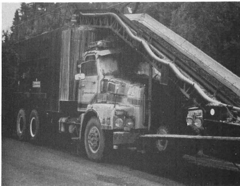
Både blandingen av tilslagsmaterialene og utleggingen blir gjort i én operasjon med denne spesialkonstruerte maskinen.
