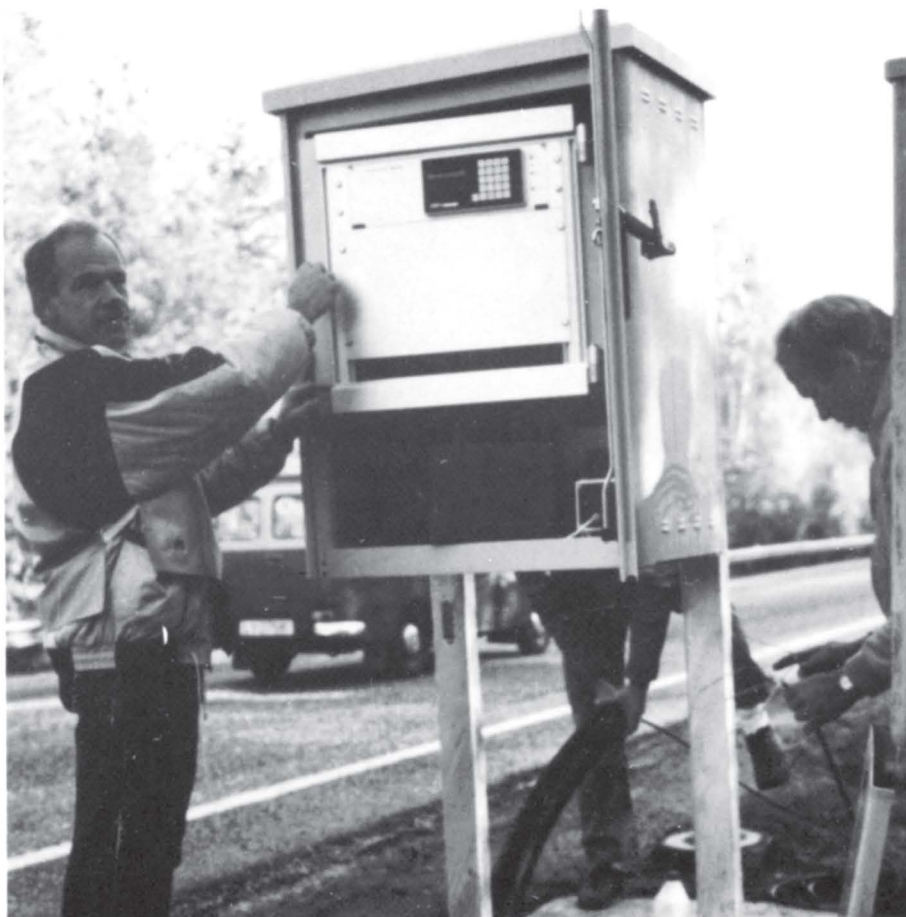
Per Härter med den nye elektroniske varslingsstasjonen på Vestmarka i Larvik. Stasjonen sender impulser til Ås, og en datamaskin varsler når trafikkstrømmen tilsier omdirigering.
