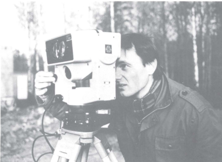
Trygve Stien, her i arbeid med Geodimeter 140 med Geodat registreringsenhet.
