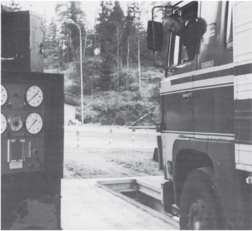
Kjøretøykontrollør Arne Rinde fra biltilsynet i Skien kontrollerer her bremsene på et vogntog.
