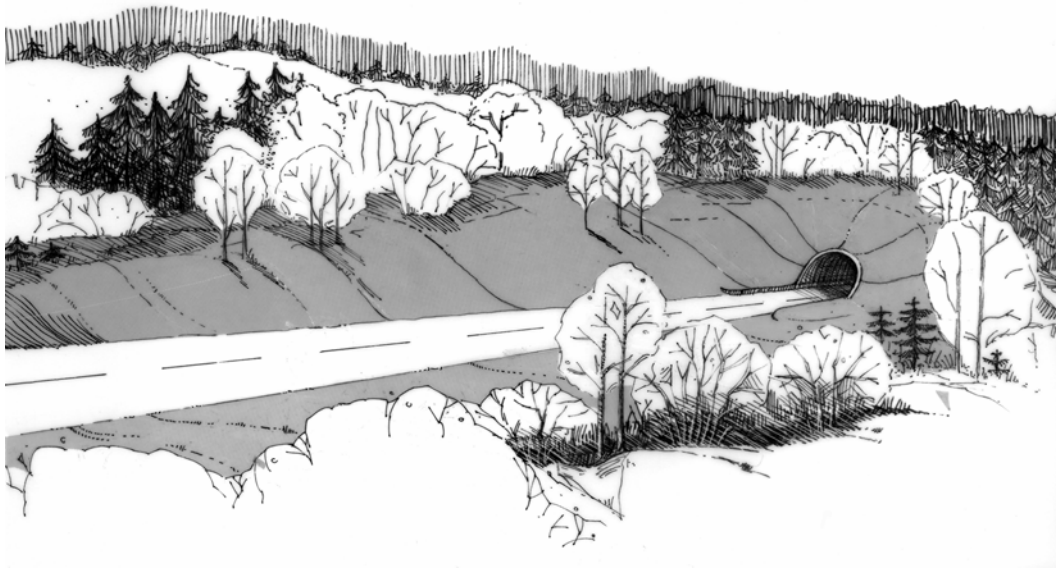
Figur 3.3 Dagsone i terreng med slak helling. For å unngå sjaktfølelsen ved innkjøringen til tunnelen, er terrenget sterkt bearbeidet. Ill.: Ingeborg Langeland Degnes.
