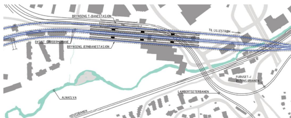
Figur 3-55 Skisse sporløsning Bryn med stasjon for regiontog (Gardermobanen), S-bane (Hovedbanen) og T-bane. I tillegg kommer buss og foreslåtte trikkelinjer fra Bryn mot Carl Berners plass/Ring 2 og til Økern/Sinsen.
