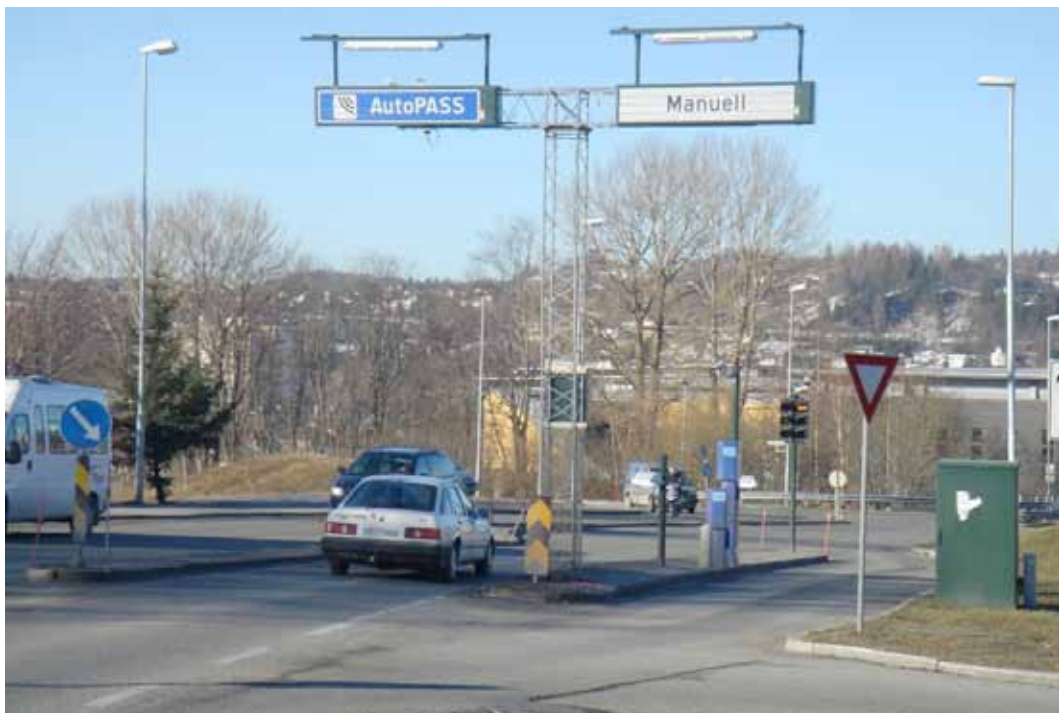
Figur 4.16 Automatiske bomstasjoner kan utnytte brikketeknologien til innsamling av trafikkdata
