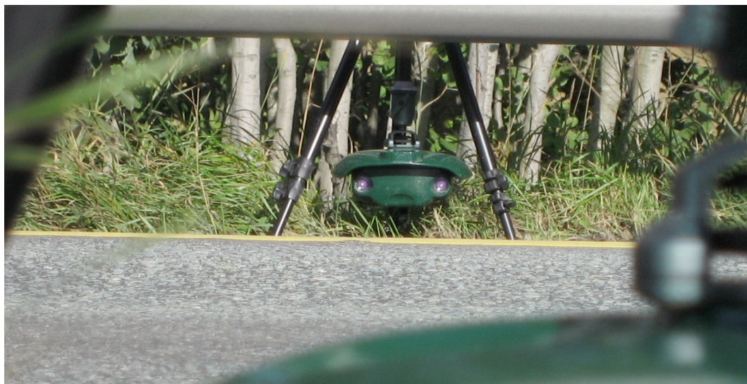
Figur 4.15 Registreringsenhet som sender ut infrarødt lys
