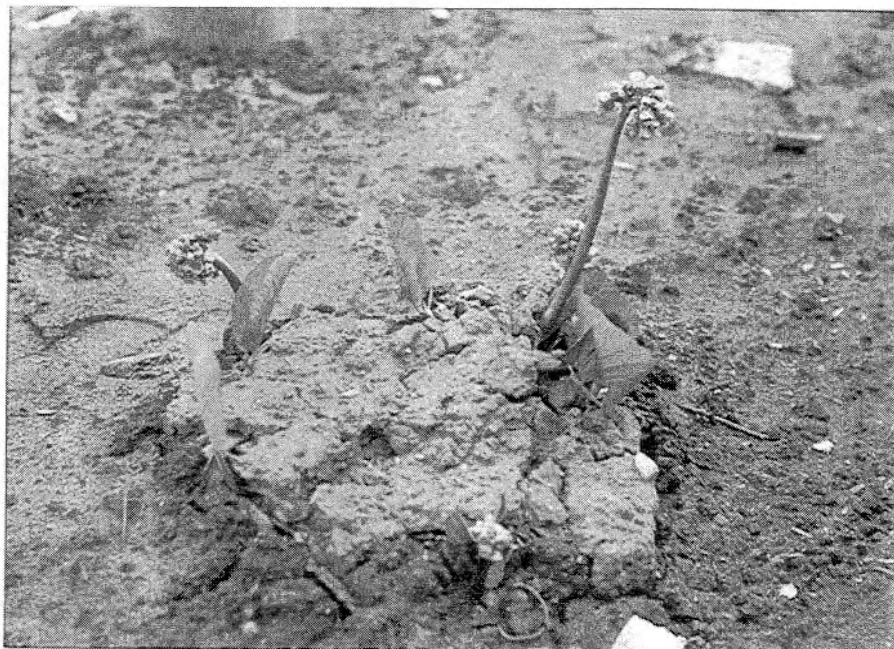
Figur 19. Piggdekk gir stor asfaltslitasje og store støvproblemer. Her vokser en bergblomst (Bergenia) gjennom et 1–2 cm tykt støvlag, som er avsatt i løpet av vinteren (E18 Blommenholm).
