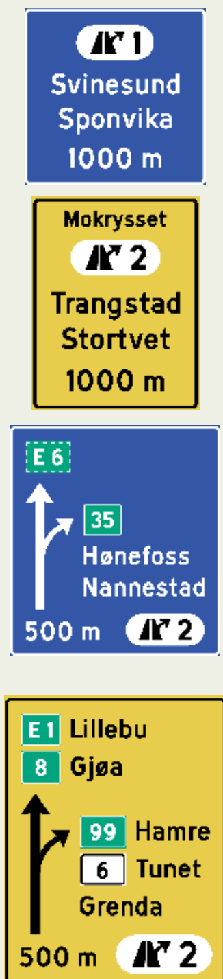
Figur 4-3.5 Eksempler på utforming av skilt 705 "Avkjøringstavle"
