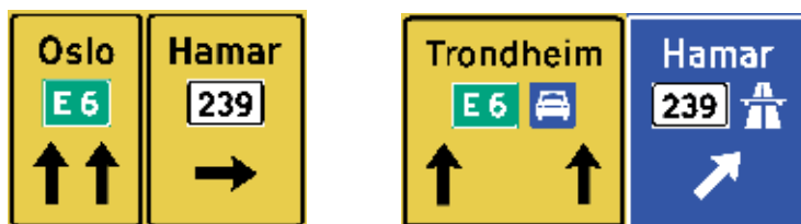
Figur 4-3.24 Eksempler på utforming av skilt 717 "Kjørefeltvegviser"
