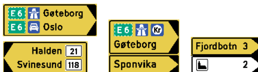
Figur 4-3.20 Eksempler på utforming av skilt 713 "Vanlig vegviser"
