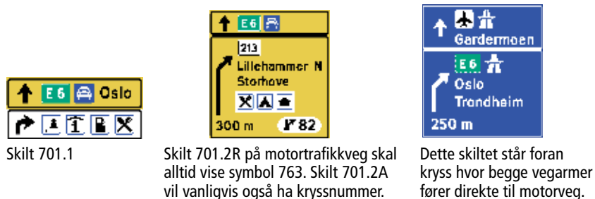
Figur 4-3.1 Eksempler på utforming av skilt 701 "Tabellorienteringstavle"
