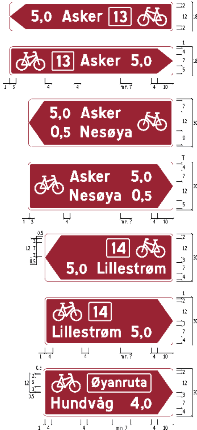
Figur 4-3.36 Utforming av skilt 751 "Vegviser for sykkelrute". Alle mål i 1/7 H.
