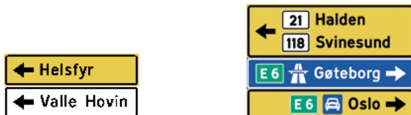
Figur 4-3.17 Eksempler på utforming av skilt 711 "Tabellvegviser"
