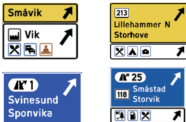
Figur 4-3.22 Eksempler på utforming av skilt 715
