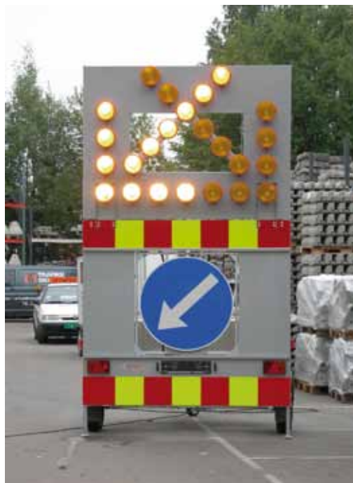
Figur 28 Eksempel på blinkende lyspil på varselpanel
