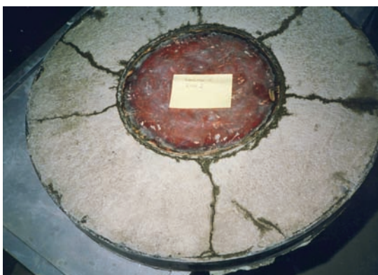
Fig. 3.6 Eksempel på hvordan en ring-prøve kan se ut ved forsøksslutt. Prøven er fuktet opp og delvis tørket for å tydeliggjøre rissene.
