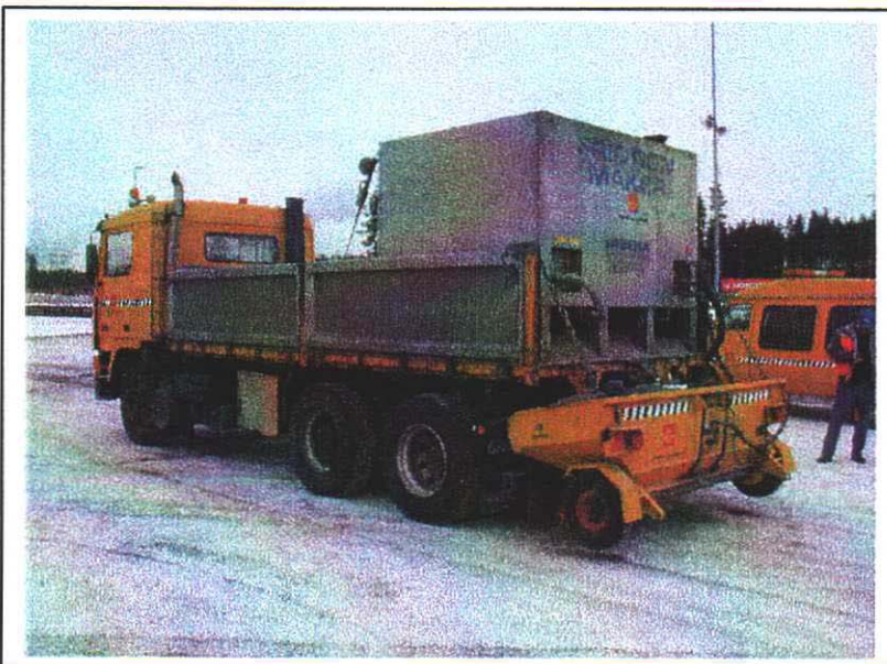
Figur 2.1: Svensk prototyp for strøing med varmbefuktet sand. Stasjonert i Oppland
