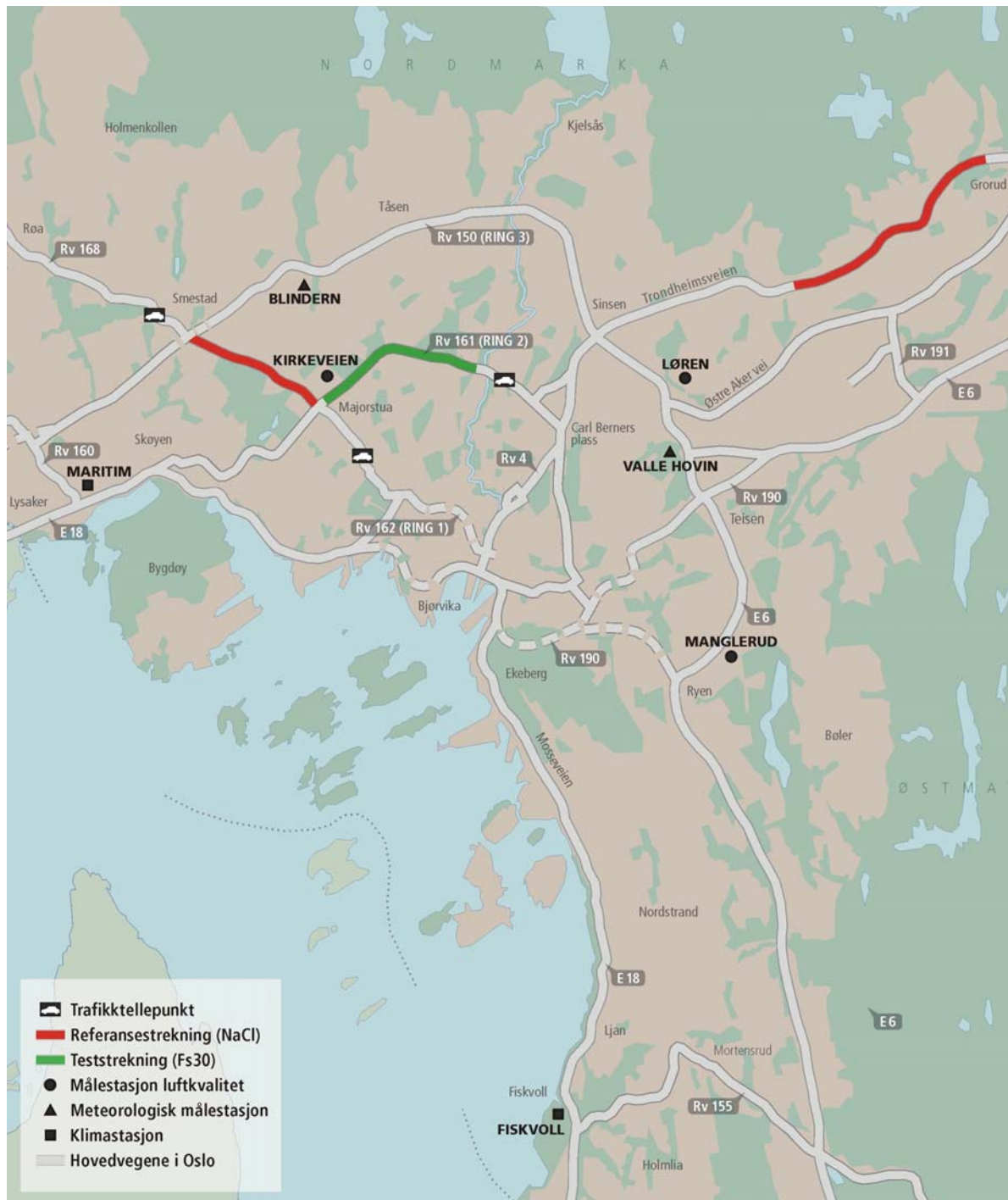
Figur 3.3: Forsøksområde hvor det er benyttet en metode med MgCl_2 -løsning som befuktning til tørt NaCl i Oslo. På referansestrekningen (Rv 168) er det benyttet befuktning med NaCl-løsning
