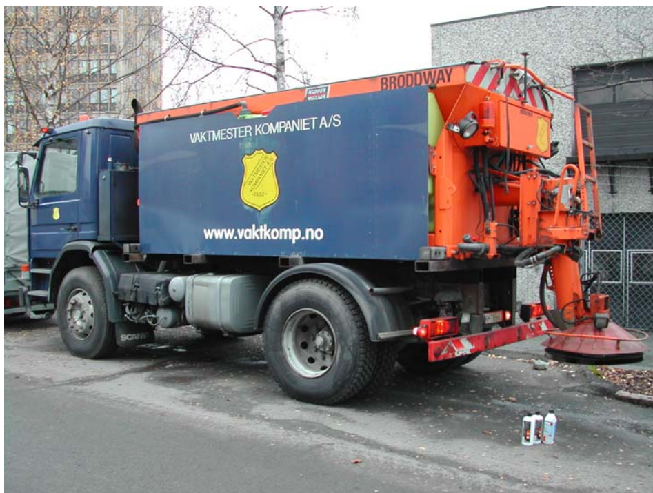
Figur 3.1: Strøbilen som er benyttet i magnesiumkloridprosjektet i Oslo
