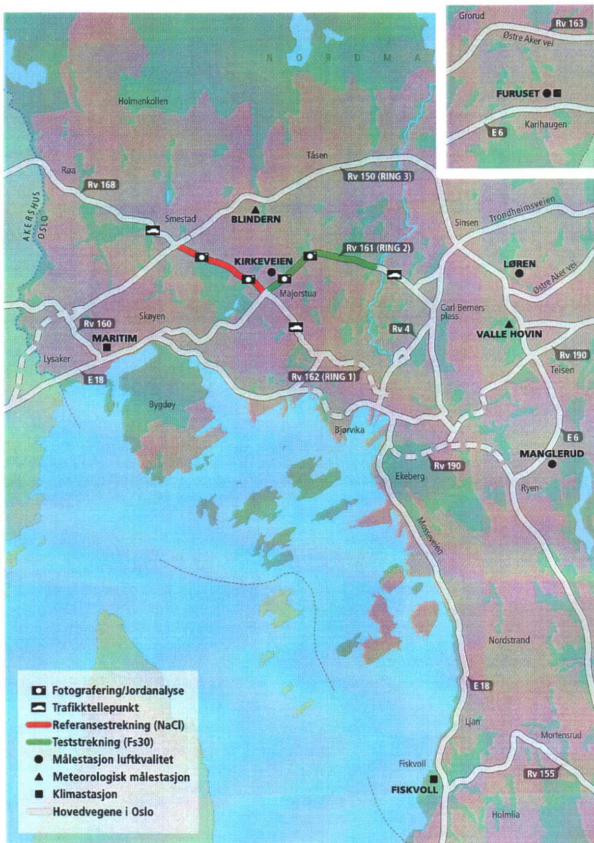
Figur 4.1: Forsøksområde hvor det er benyttet en metode med MgCl_2 -løsning som befuktning til tørt NaCl i Oslo sesongen 2001/2002. På referanserekningen er det benyttet tørt salt
