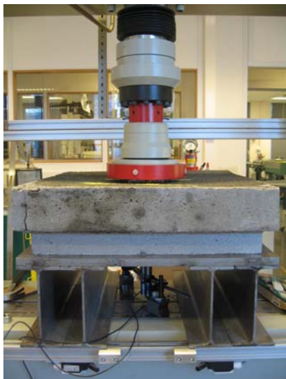
Figur 10 Prøving av energiabsorpsjon på kvadratiske prøveplater
