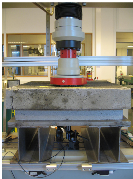
Bestemmelse av energiabsorpsjon på kvadratiske prøveplater med kontinuerlig opplegg (NS-EN 14488-5)
