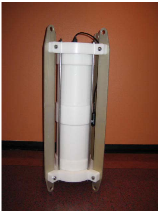
Figur 3 Registreringssystem montert i en beholder
