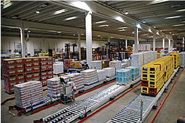
Figur 40 Automatisk varetransport for dagligvarer i COOP.
