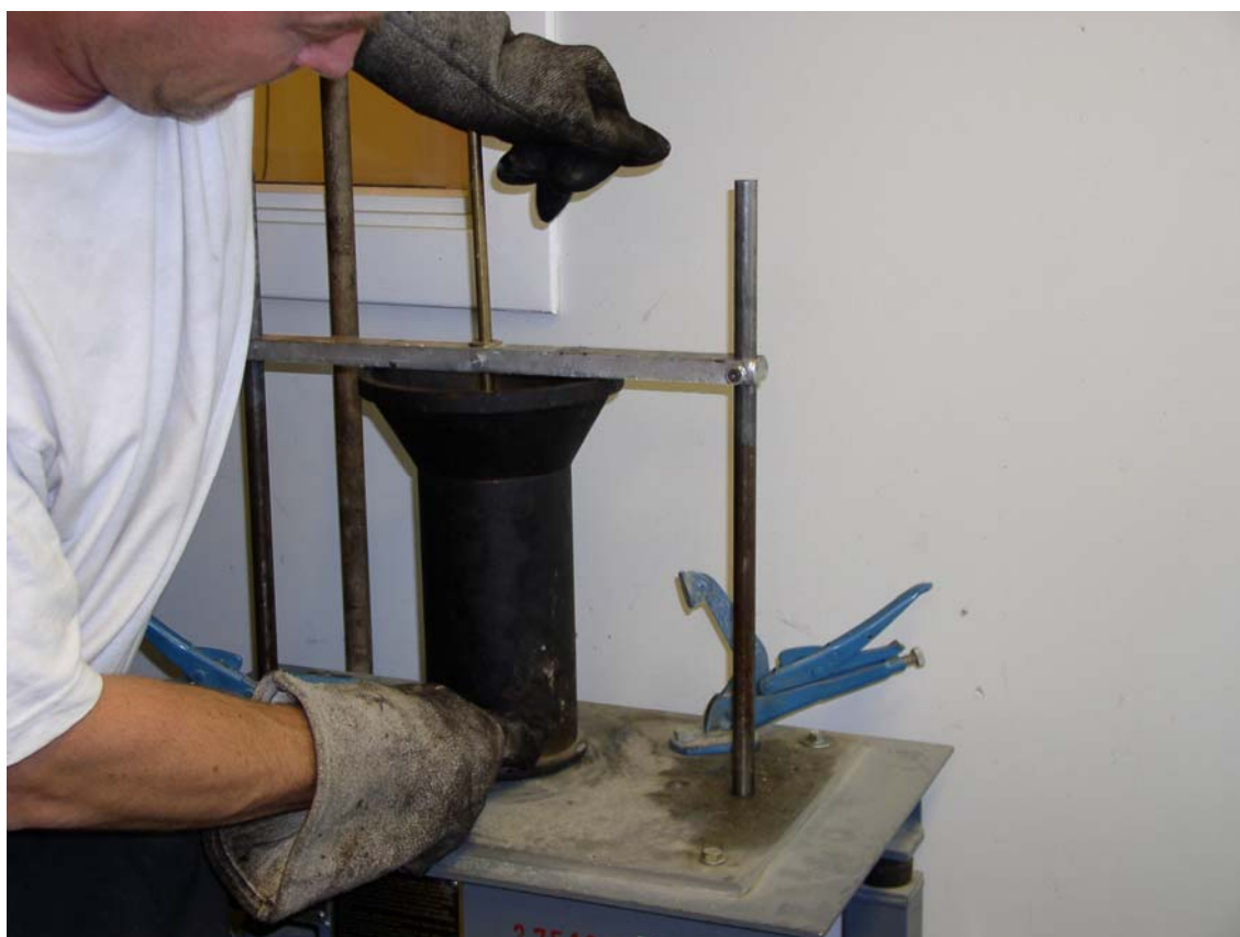
Figur 2 Tillaging av prøver ved bruk av vibrasjonsbord.
