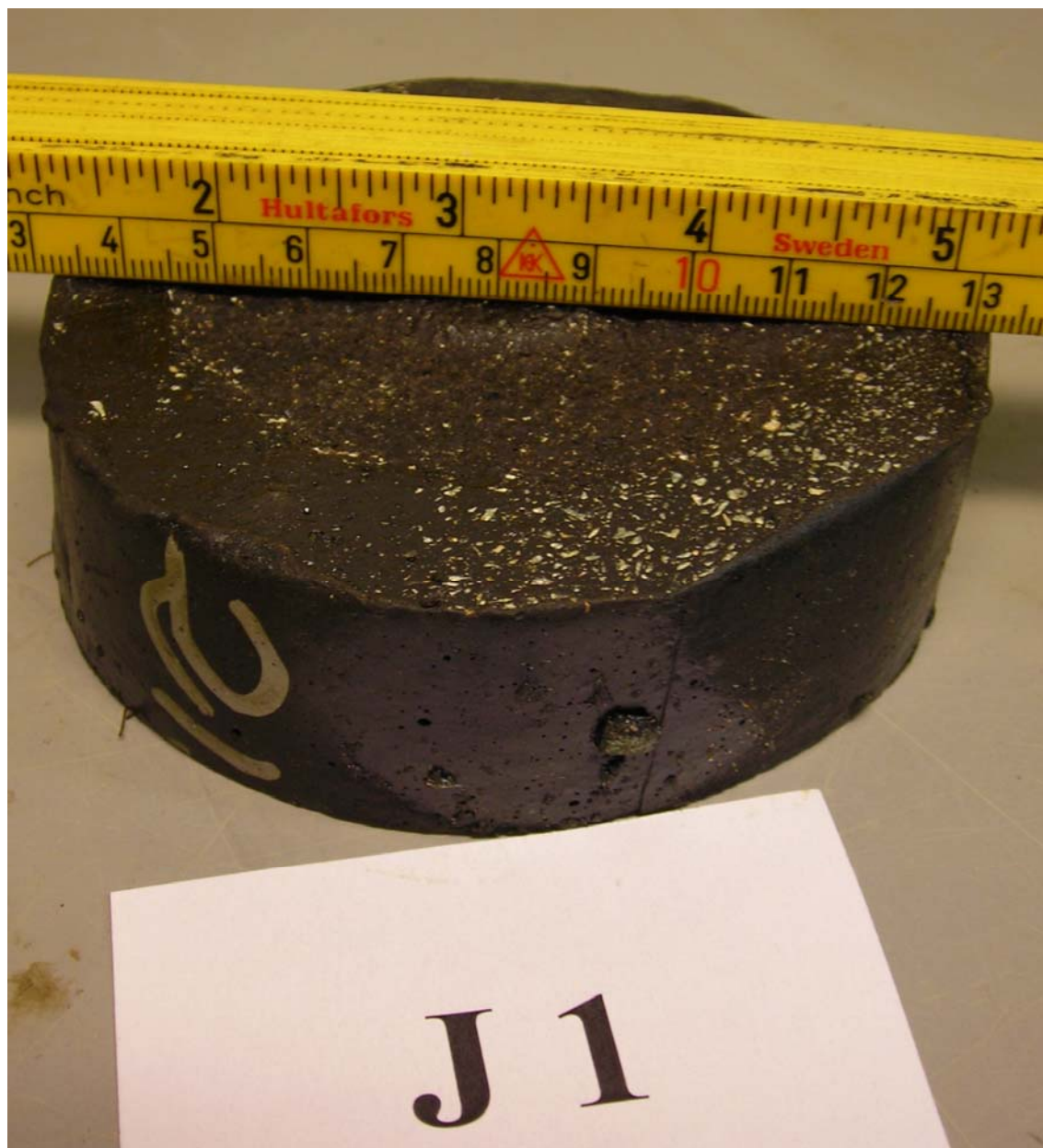
Figur 9 Sta 2 med Cariphalte DM med bindemiddelinhold på 21,4 % etter våt-testing i Trøger
