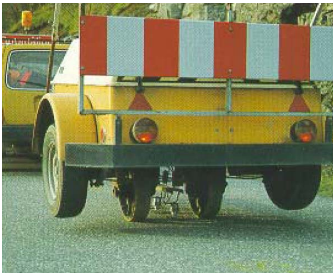
Figur 4.4 Måling av nedbøyning ved bruk av Dynaflect.
