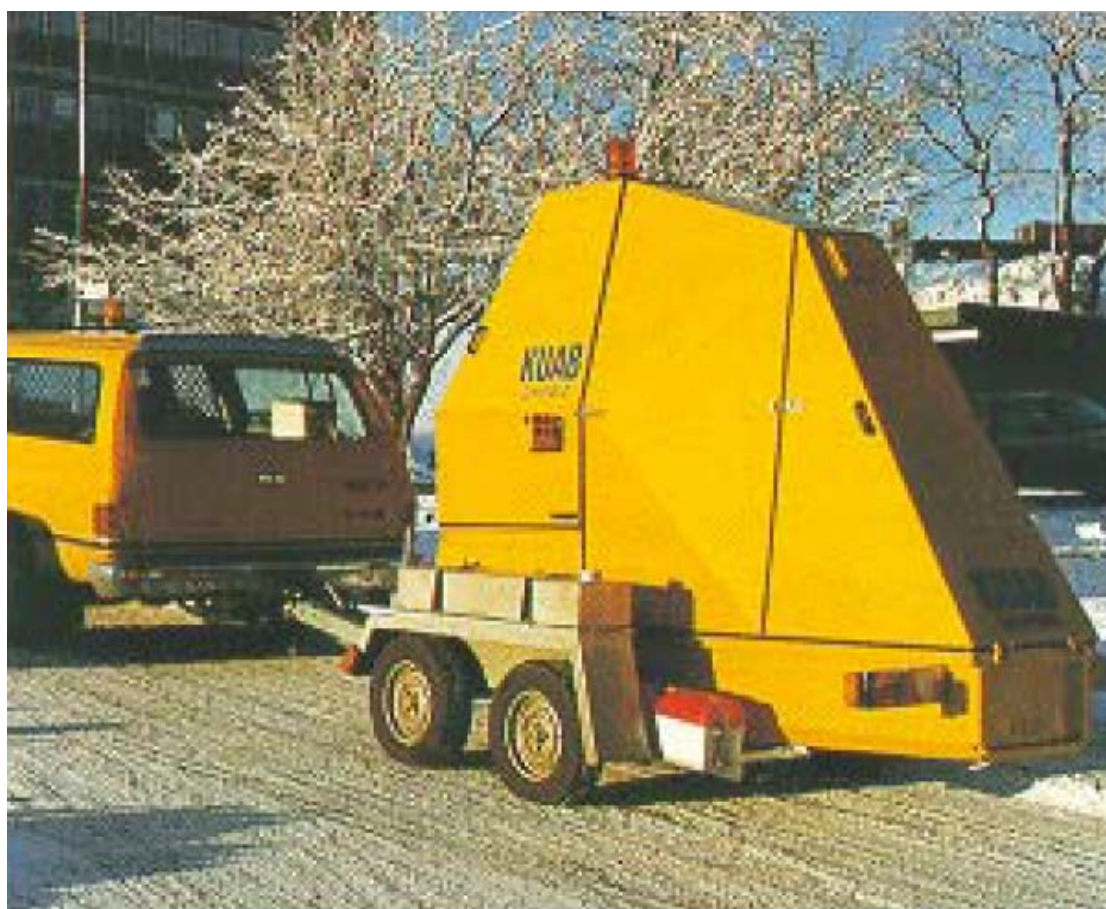
Figur 4.5 Falloddet kan måle vegens bæreevne ved å utsette den for støtbelastninger.
