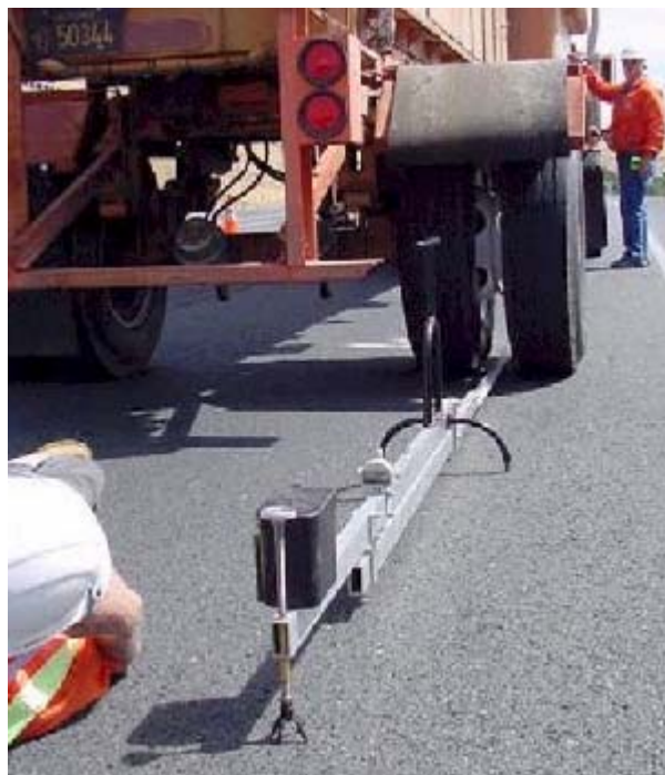
Figur 4.3 Nedbøyningsmåling ved bruk av "Benkelmansmetoden".
