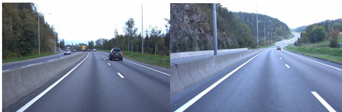
Figur 3.10 Målebilene tar bilder for hver 20. meter mens vegen blir målt.
