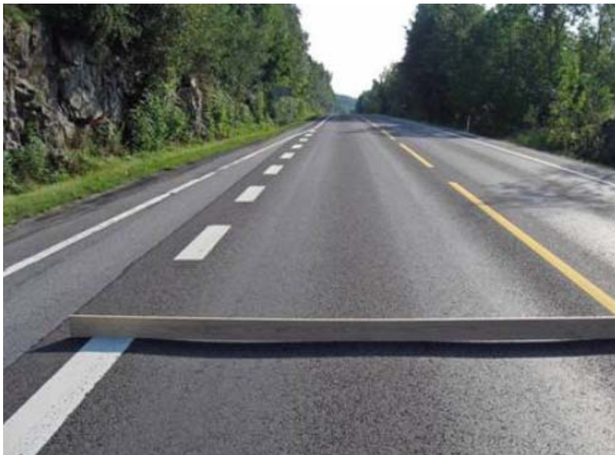
Figur 3.2 Initialspor rett etter dekkefornyelse.
