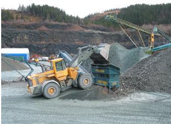
Figur 3.5: Materialproduksjon; utsiktning og transport
