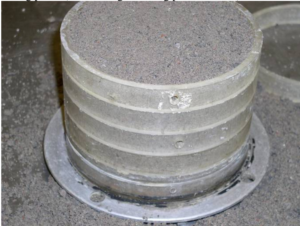
Prøvesylinder satt til midlertidig lagring (tilnærmet 100 % RF)
