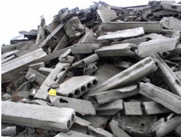
Figur 3.3: Utgangsmaterial for gjenbruksbetongen brukt på Melhus
