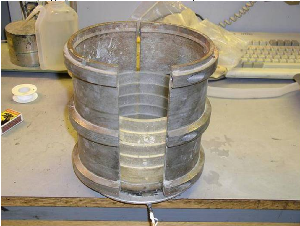
Innstampingssylinder av stål monteres utenpå
