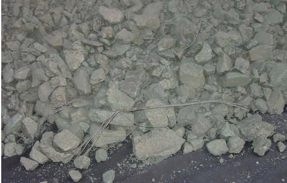
Bilde 6: Rester av armering i gjenbruksbetongen
