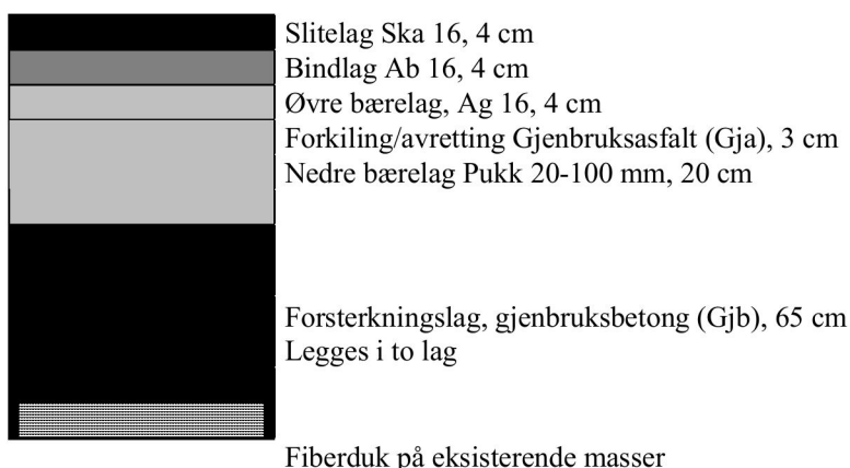
Figur 1: Overbygning på forsøksfelt med knust betong
