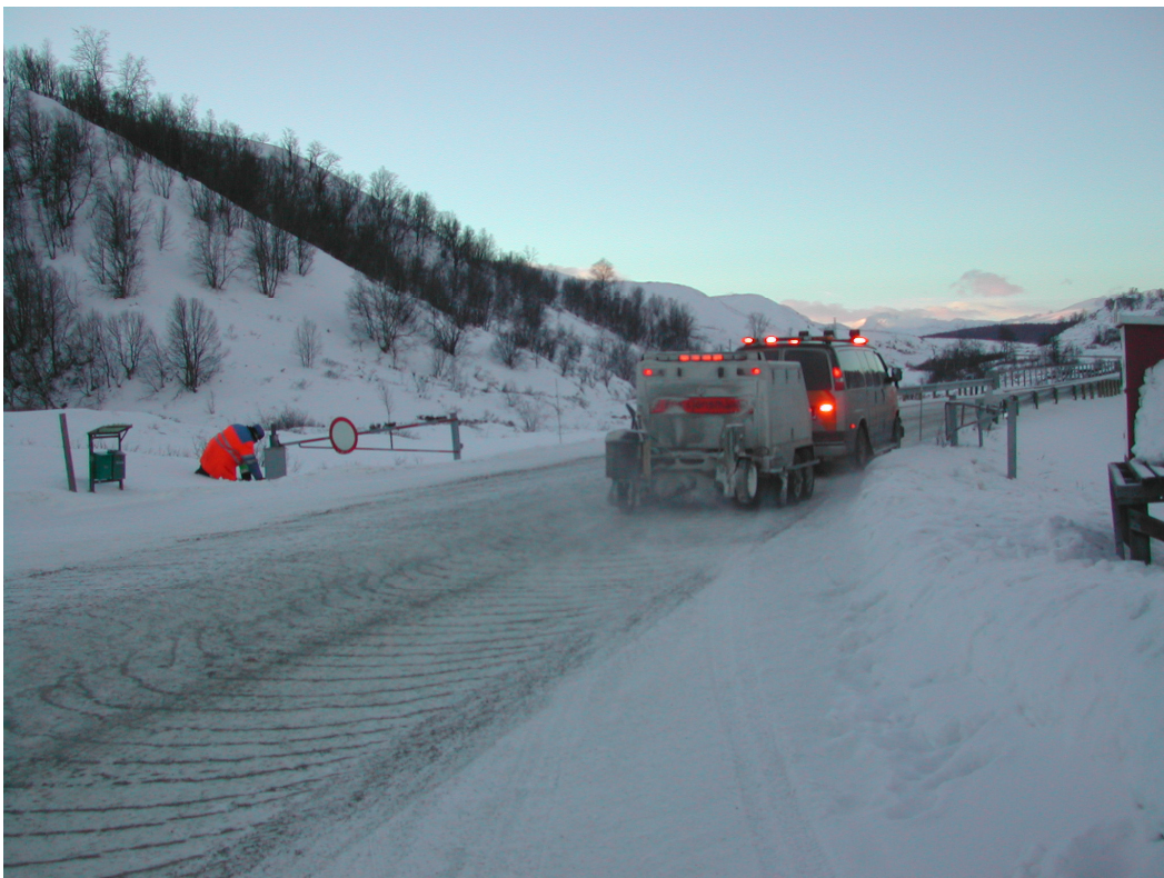
Figur 2.27: Friksjonsmåling med Roar Mark III
