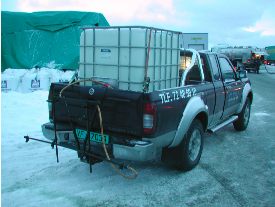
Figur 2.8: Rigg for utspredning av ICE-AWAY
