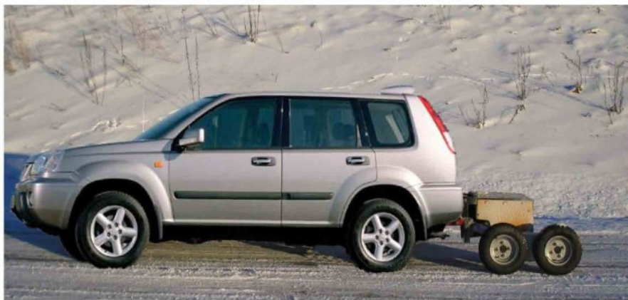
Figur 3.59: Friksjonsmåler som ble benyttet under testene 3. – 4. februar
