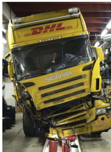
Figur 5: Skader i front på Scania trekkbil.
