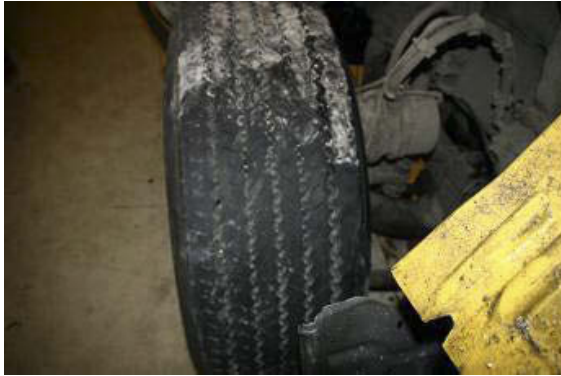
Figur 11: Dekkutrøstning styrende hjul: Continental HSW 385/65R22,5 M+S 9 mm mønster.
