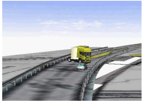
Figur 18: Illustrasjon fra simuleringene som viser hvordan vogntogets posisjon kan ha vært rett før kollisjonen med Focus.
