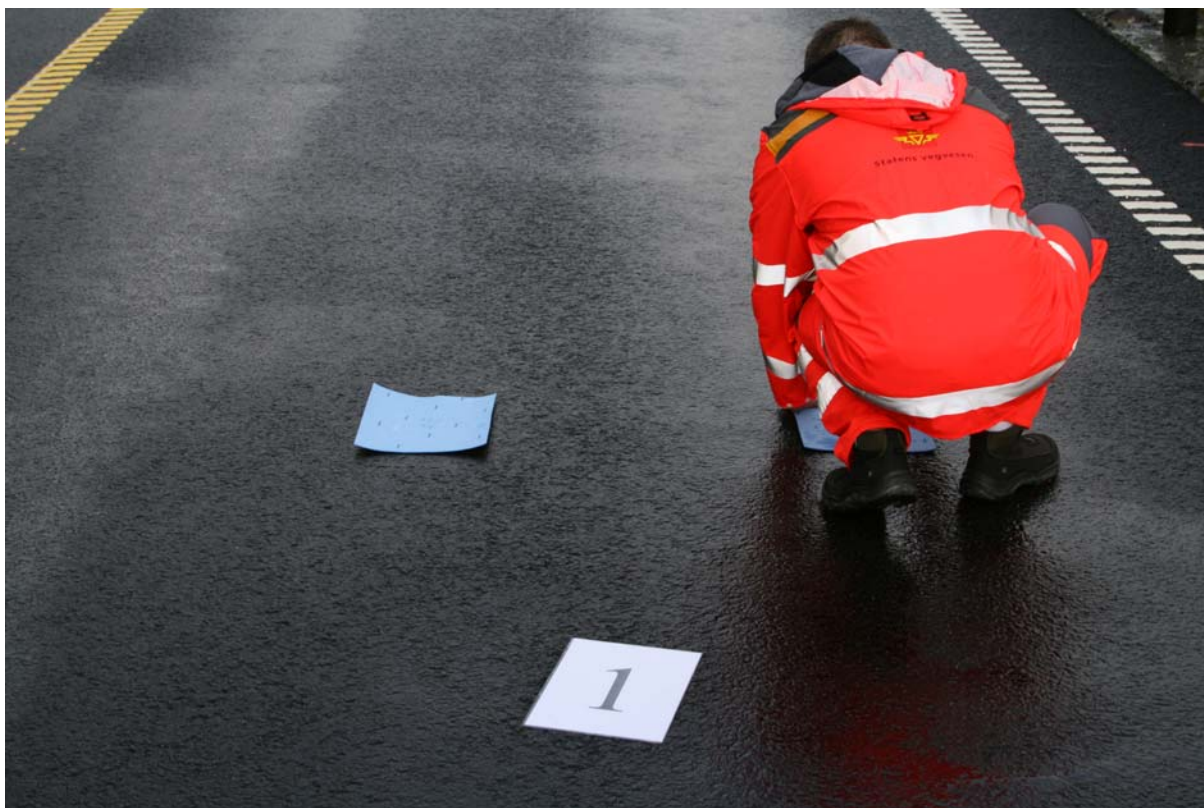
Figur 5-6: Bruk av Wettex til oppsamling av fuktighet
