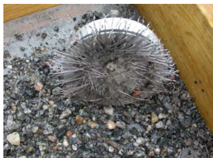
Oppsamling av stålfiber ved hjelp av magnet
