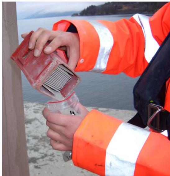
Uttak av betongstøv til kloridanalyser i forbindelse med en masteroppgave
