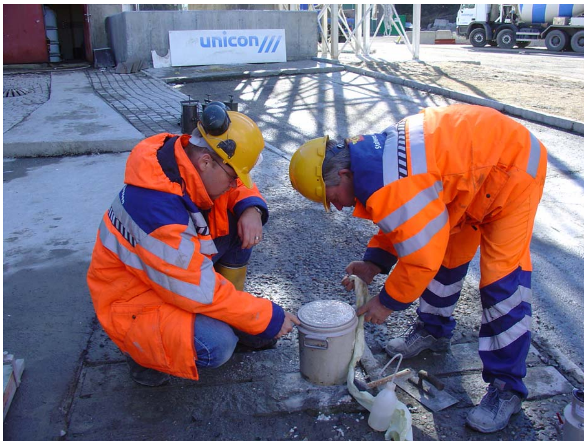
Fersk betongprøving ved Unicon AS sitt anlegg på Lørenskog
