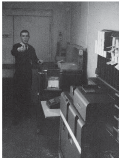
Bakke ved oversetteren 557 og med reproduseren 519 i forgrunnen
