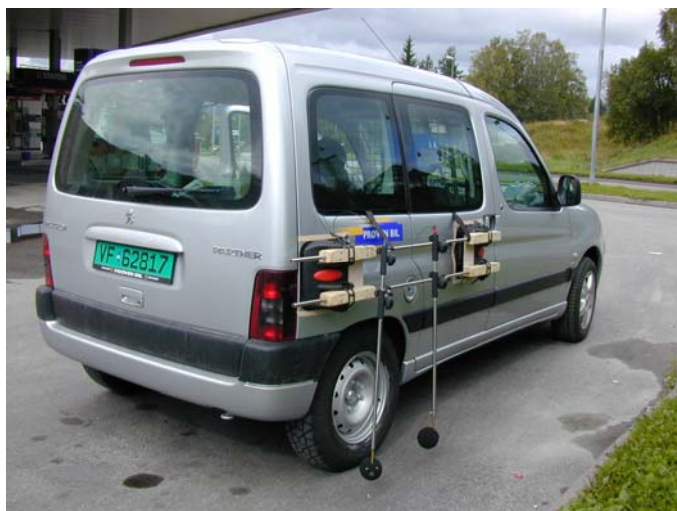
Figur 2.1 Målebil med mikrofonposisjoner.
