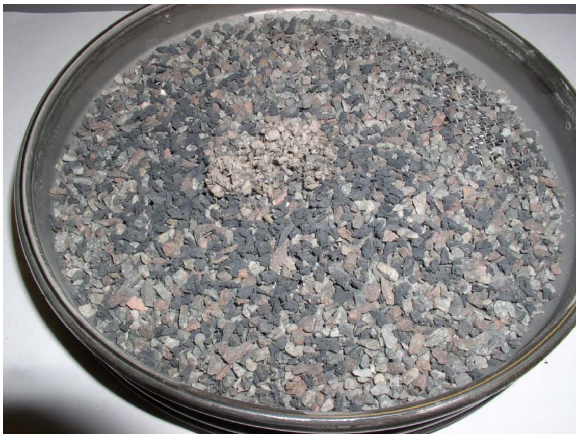
Figur 7 Gummipartikler på sikt ved bestemmelse av kornfordelingskurve for T8g
