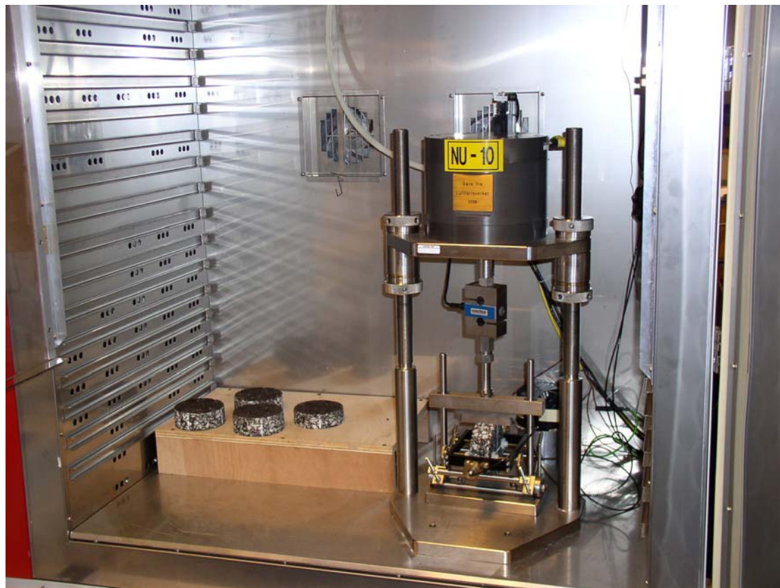
Figur 5 Bestemmelse av E-modul i Nottingham Asphalt Tester (NAT)
