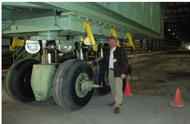
Figur 7 Hjulunderstell til B777 og ingeniør
