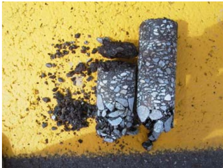
Figur 22 Gardermoes gamle dekke gikk fullstendig i oppløsning
