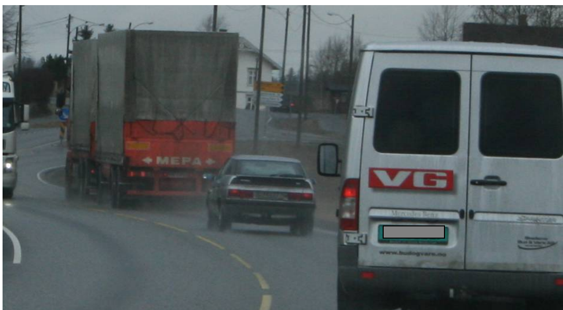
Figur 59: Biletet viser lastebil på V1 ( Skall ) kl 13:42. Det er tydelig meir sprut frå lastebilen her enn på forsøksdekket på forsøksstrekning 2 vist i forrige figur.
