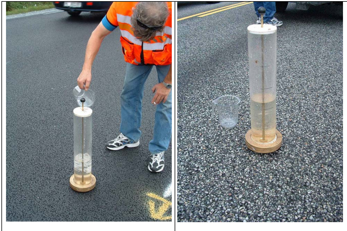
Figur 14 Påfylling av måleutstyr (venstre) og utstyr klart til permeabilitetsmåling (høgre)
