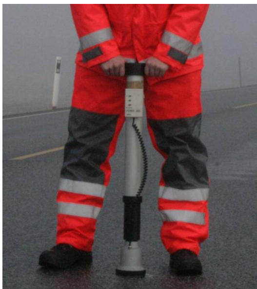
Figur 45a: Måling av salt på vegbane med SOBO 20.
