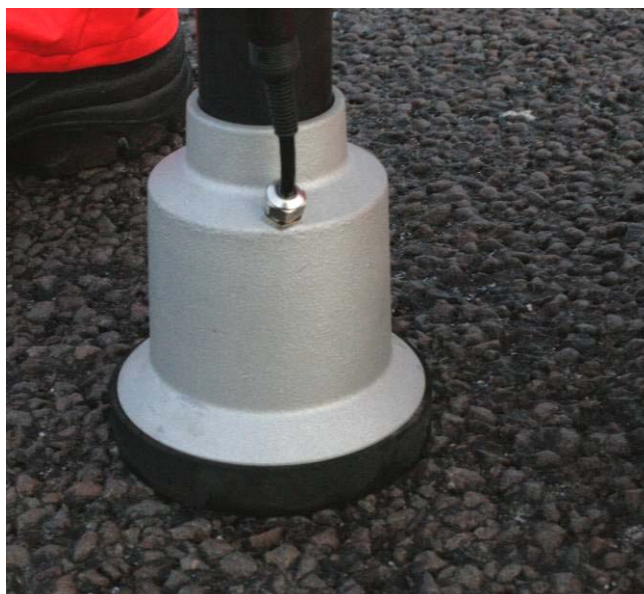
Figur 45b: Munnstykke som omslutter målearealet på SOBO 20.
