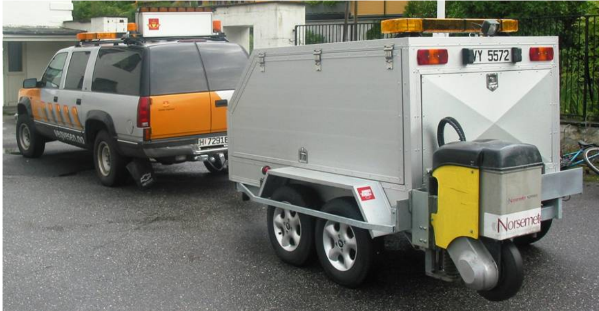
Figur 29: Statens vegvesen sin friksjonsmålar Mark III
