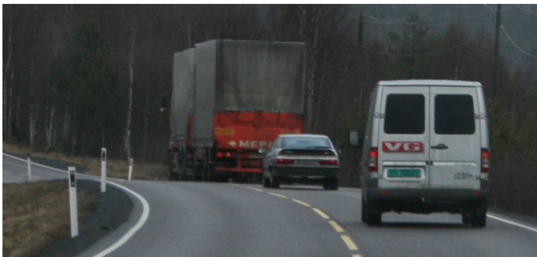
Figur 58: Biletet viser en lastebil på strekning FF2 ( porøs asfalt ViaQ11/ViaQ16 ) kl 13:41. Det er mest ikkje sprut frå dekk på lastebilen.
