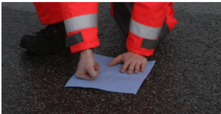
figur 44: Måling av fukt på veg med Wettex-tekstil.
