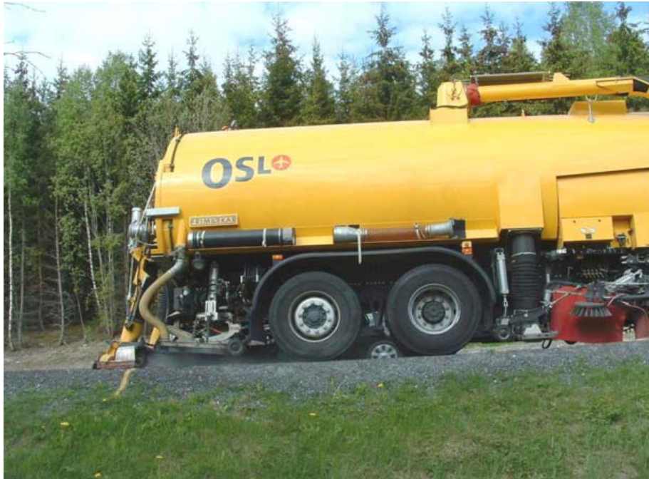
Figur 10. Rensemaskin Frimokar, som høytrykksspyler vegdekket og sug opp vaskevattnet. /P4/
