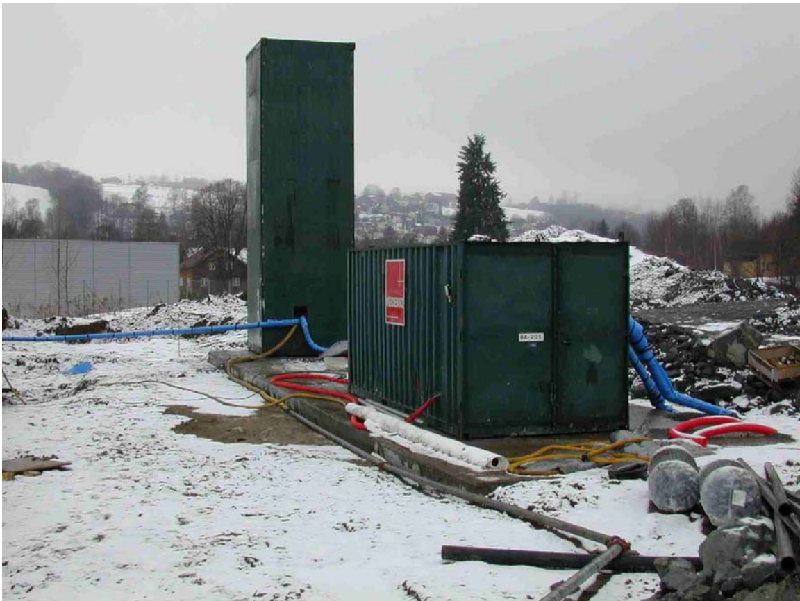
Figur 12. Sandfilter (Wøyen) for fjerning av partikler ned til en konsentrasjon under 100 mg SS/l.
