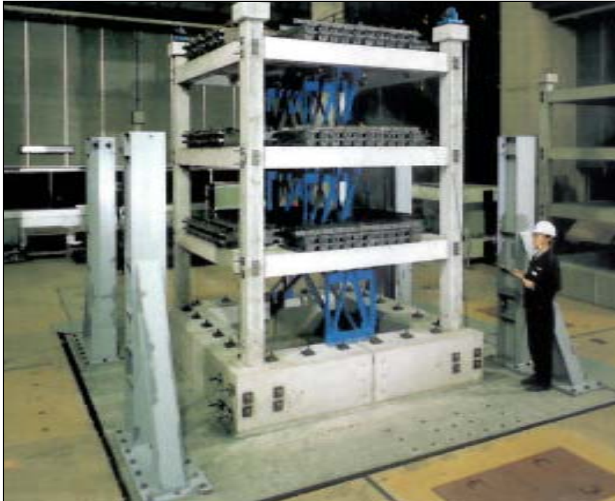
Figur 6 Plattform for jordskjelvsimulering. I dette tilfellet en forspent betongramme.
