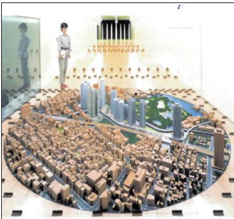
Figur 7 Modell av by i vindtunnel.
