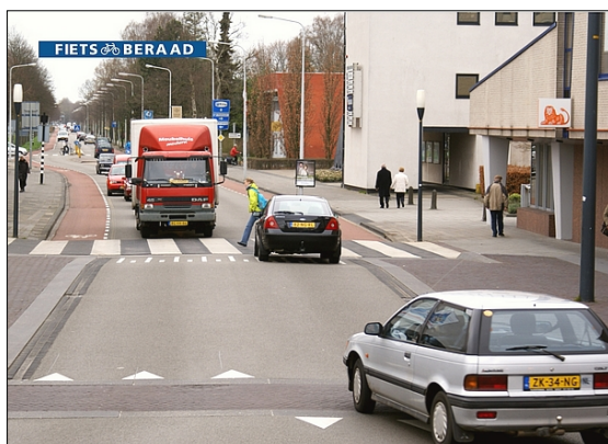
Figur 21 Sykkelovergang i forkant og fotgjengerovergang i bakkant.
