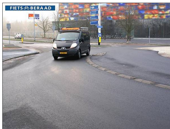
Figur 13 Ekstra kjørefelt inne i rundkjøringen som følger halve rundkjøringen.
