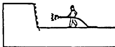
2. ARMERINGSNETT OG SPRØYTEBETONG PAFØR
