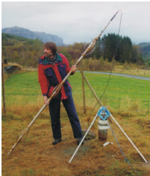
Figur 1. Akustisk Televiewer, AKTV sonde (venstre), måleprinsipp (høyre)
