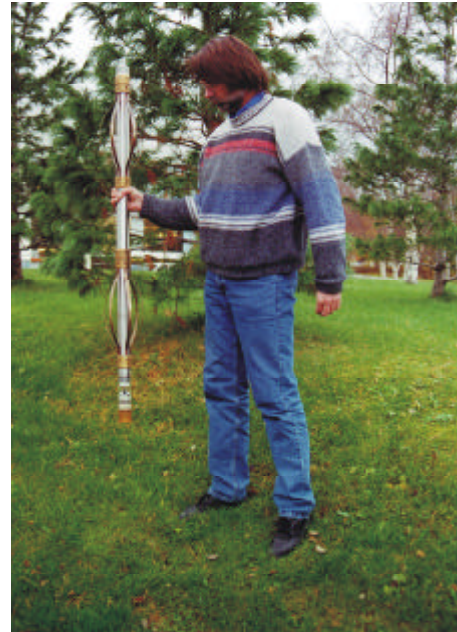
Figur 2. Måleprinsipp for Optisk Televiewer, OPTV (venstre), sonde (høyre) (Robertson Geologging).
