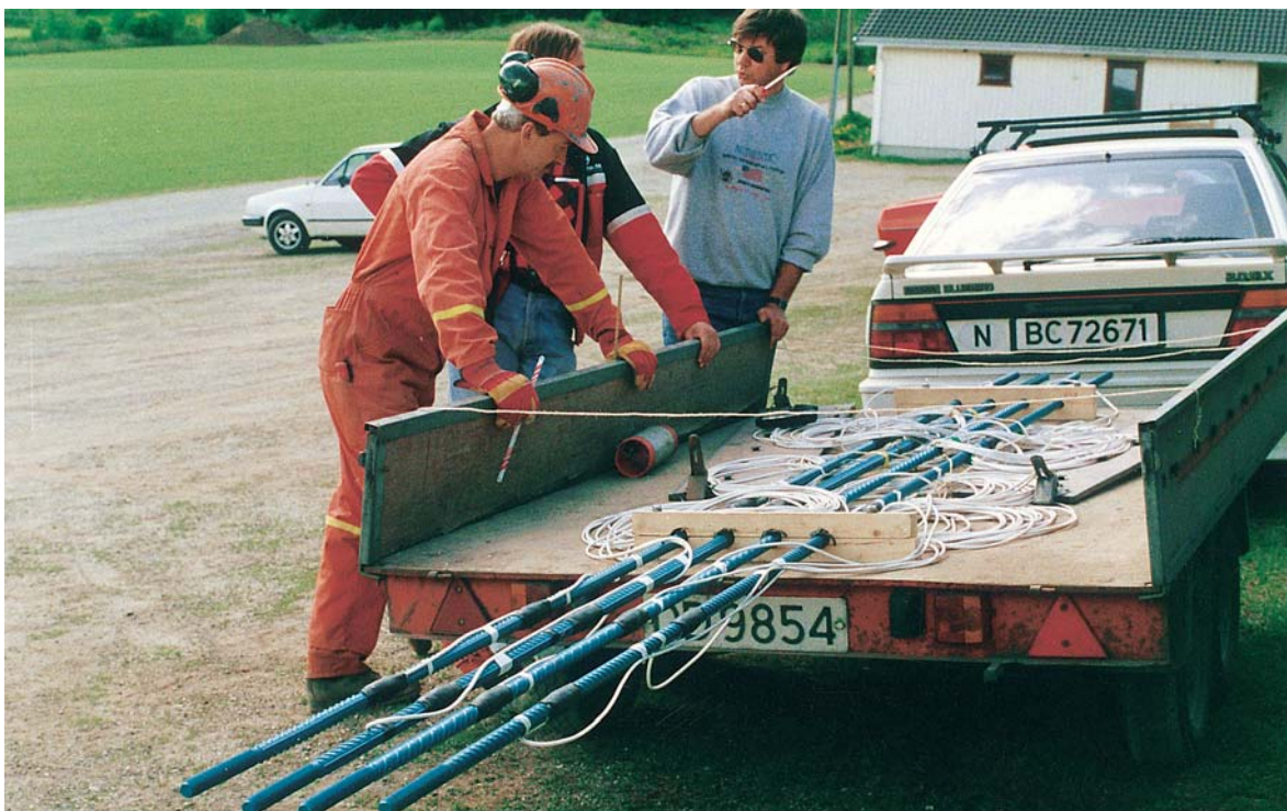
Bilde 12: 4 instrumenterte jordnagler med totalt 40 strekkklapper.
