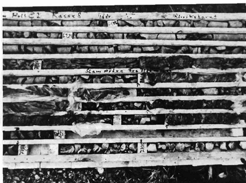
Fig. 5. Ved forsiktig boring er det mulig å få opp kjerner av finknuste, leirlignede materialer. For å bevare den naturlige konsistens best mulig er materialet pakket inn i folie.
