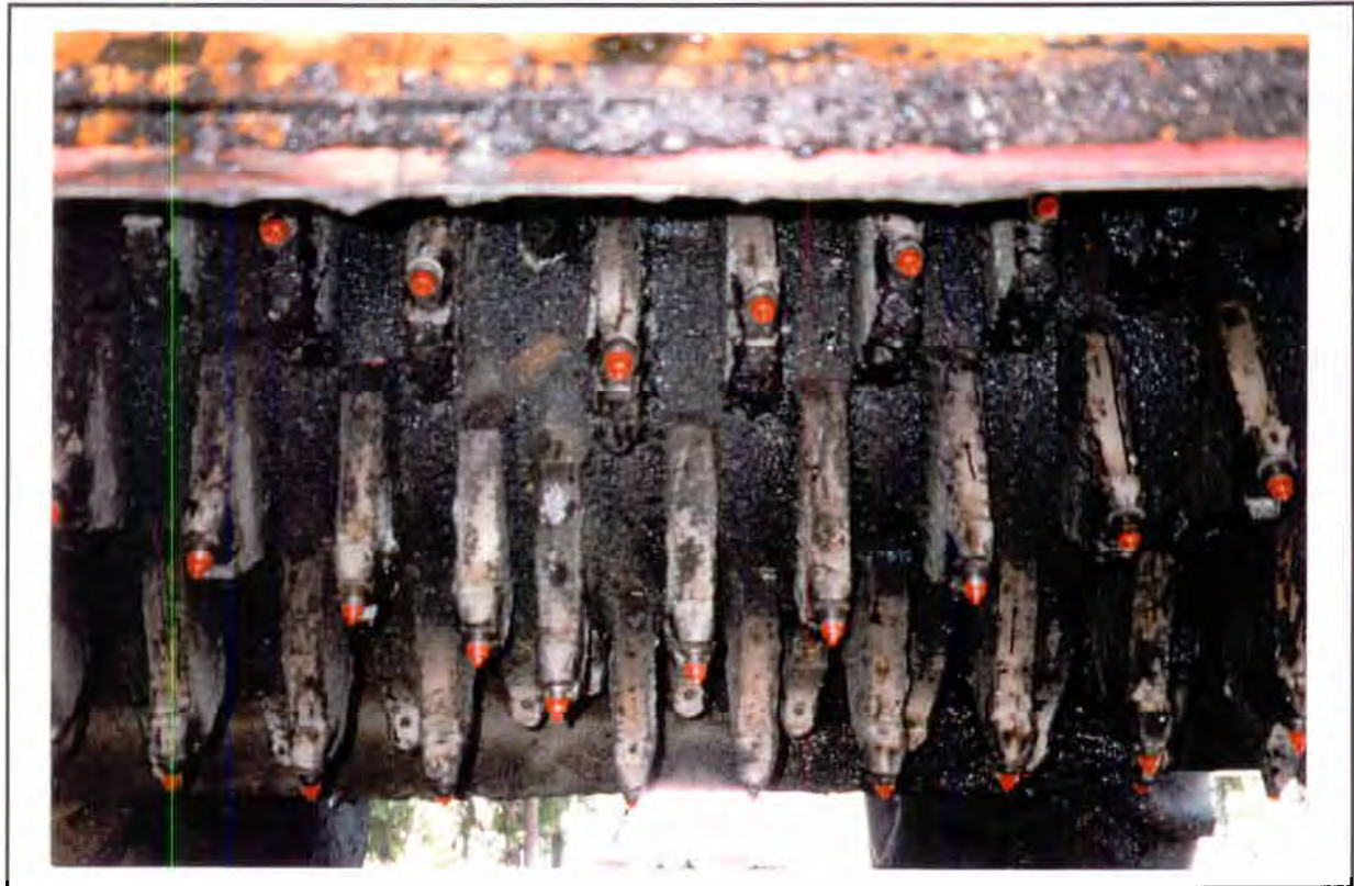
FIGUR 4 Fresetennene med dyser for bindemiddeltilsetting
