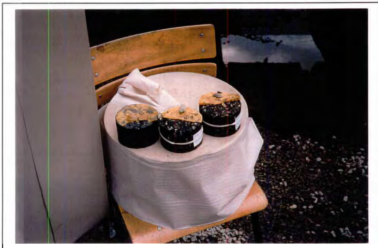
FIGUR 12 Prøveklosser for indirekte strekk-forsøk
