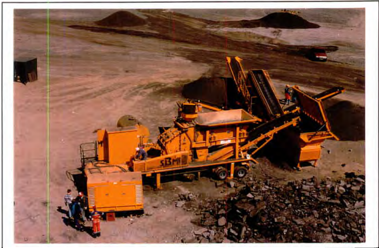
FIGUR 24 Granulatorens som ble brukt til å knuse asfaltflak
