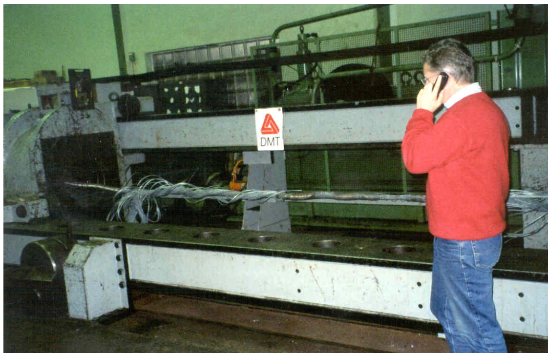
Foto 9. Suppleringskabel. Brudd oppstod på fri lengde.
