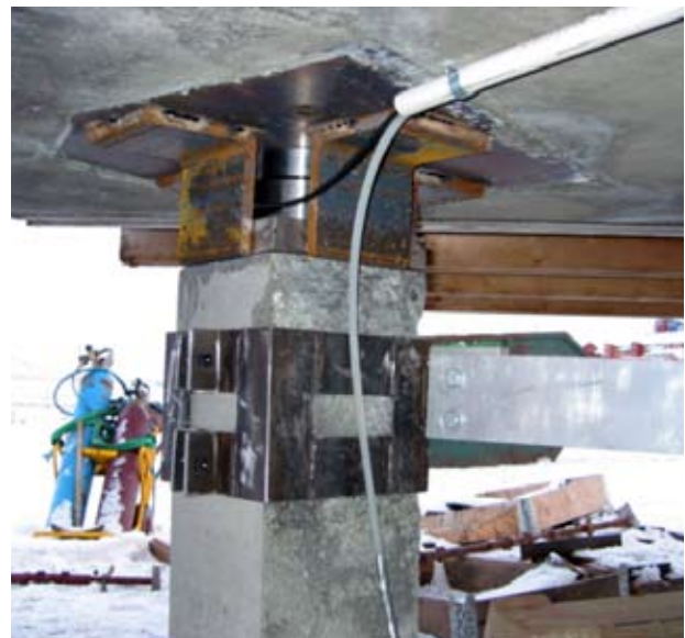
Figur 7. Lastcelle ved peletopp. (Foto: Bjarne Engene)
