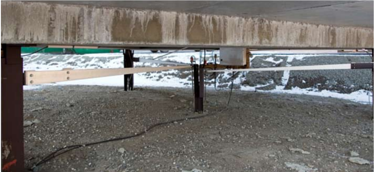
Figur 9. Arrangement for setningsmålere. (Foto: Birger Amundsen)
