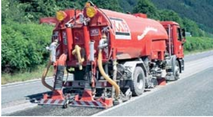
Figur 41: FRIMOKAR, friksjonsforbedrende utstyr [5]
