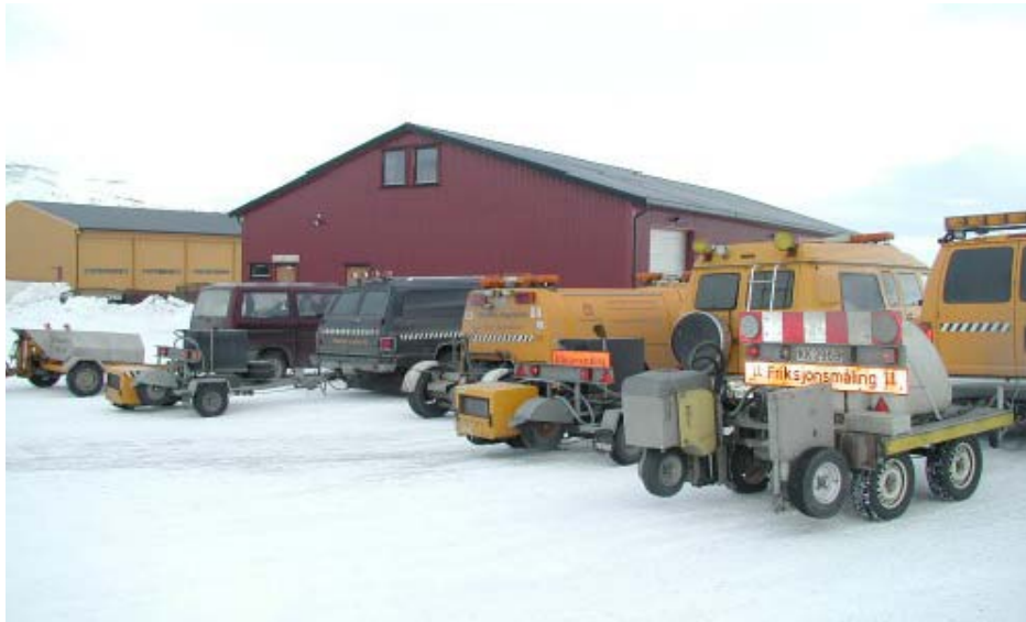
Figur 20: Friksjonsmålere som benyttes av Statens vegvesen [23]
