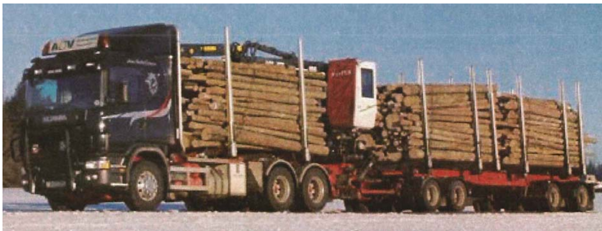
Figur 5.15 Standardisert 7 - akslet tømmervogntog, tilpasset et 8 tonns vegnett. (Gjengitt med tillatelse fra Kjell Messenlien, Akershus- og Østfold Virkestransport)
