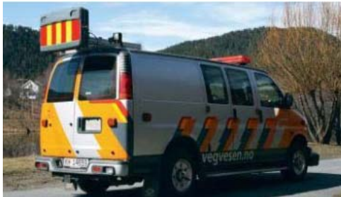
Figur 4.1. Målebil for tilstandsmålinger (roterende laser)
