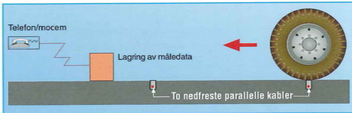
Figur V24.1. Eksempel på "Weighing in motion" Ref nr.(BUAB)
