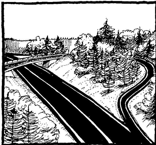
Figur 28.10 Eksisterende naturlig vegetasjon er en ressurs i veganleggene. Ved å ta vare på vegetasjonsarealer f.eks. i planskilte kryss vil arealene som må istandsettes og vedlikeholdes bli mindre.
