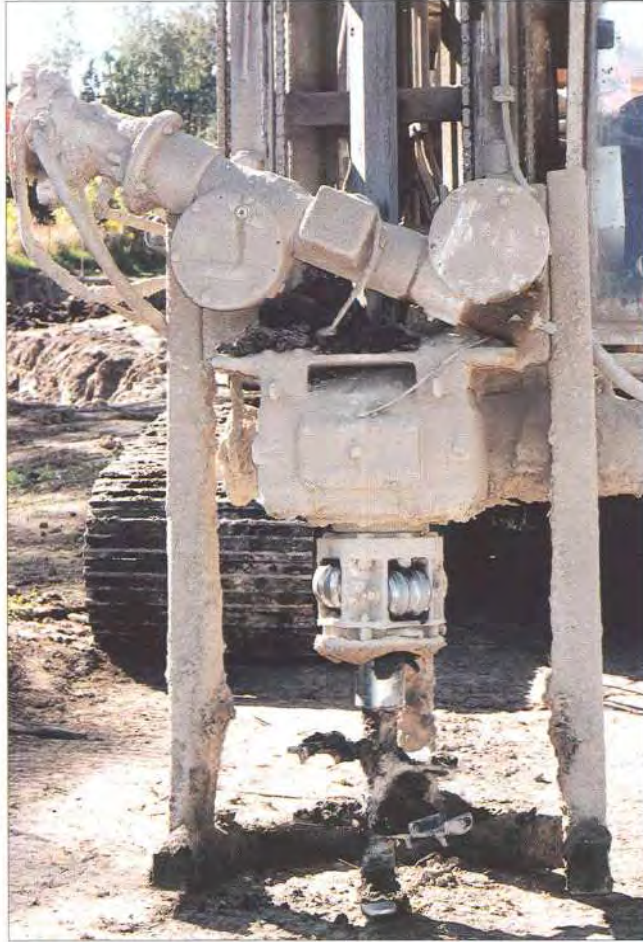
Figur 1-7- 10 Bildet viser et av innblandingsverktøyene som finnes på markedet i dag.
