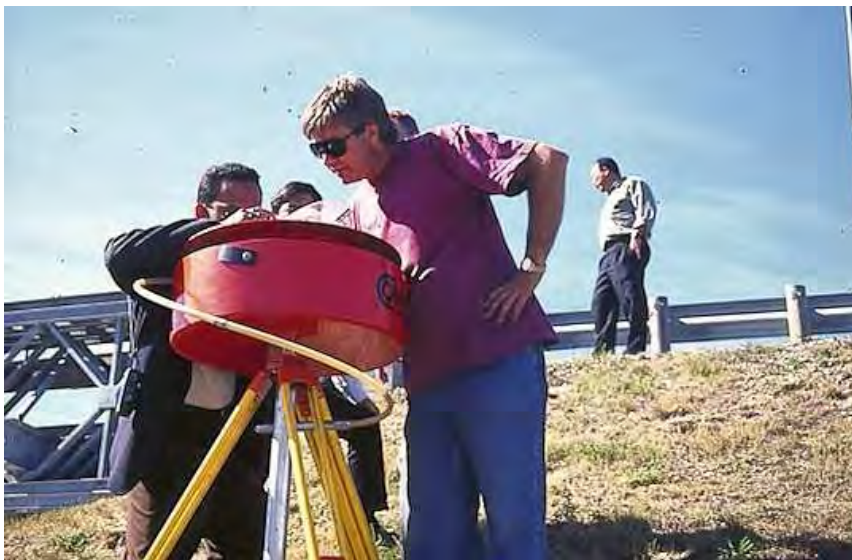
Figur 1-1- 6 Slangesetningsmålerutstyr i bruk ved Løkkeberg bru, Østfold (Foto: Roald Aabøe)
