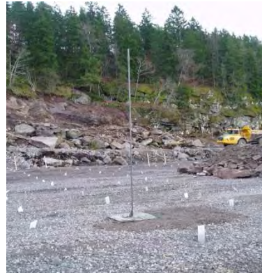
Figur 1-1- 4 Målestenger for setninger i grunnen under fylling (Foto: C. E. Dahl).
