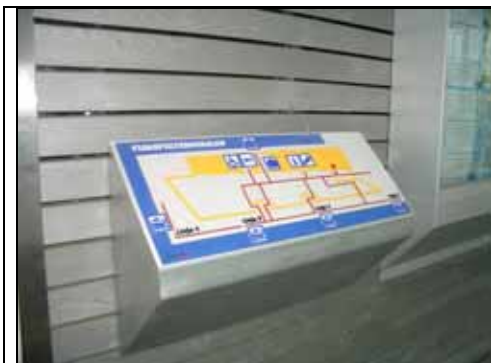
Bilde 65 Fiskepirterminalen, Stavanger. Taktilt kart som gir oversikt over knutepunktet. Kartet har også god lesbarhet for seende og er et godt eksempel på universell utforming av denne type informasjon.
