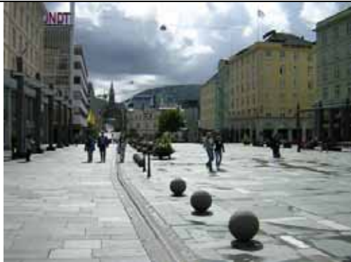
Bilde 10 Torgallmenningen, Bergen. Rennesteinen over plassen kan brukes som ledelinje understøttet av flere møbleringselementer som angir retningen. Kirken skimtes i det fjerne, og fungerer som et fondbygg og en retningspeiler. Rennesteinen er imidlertid vanskelig å følge med føttene. (steinene langs plassen kan derimot gi snublefare)
