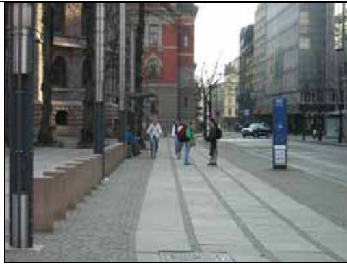
Bilde 12 Akersgata, Oslo. Helleene er gode å gå på og avgrensningen mot gatestein gir en naturlig ledelinje. Pullertene og gatelysene som står på rekker utgjør også en slags naturlig visuell ledelinje som er med på å understreke retningen på gata.
