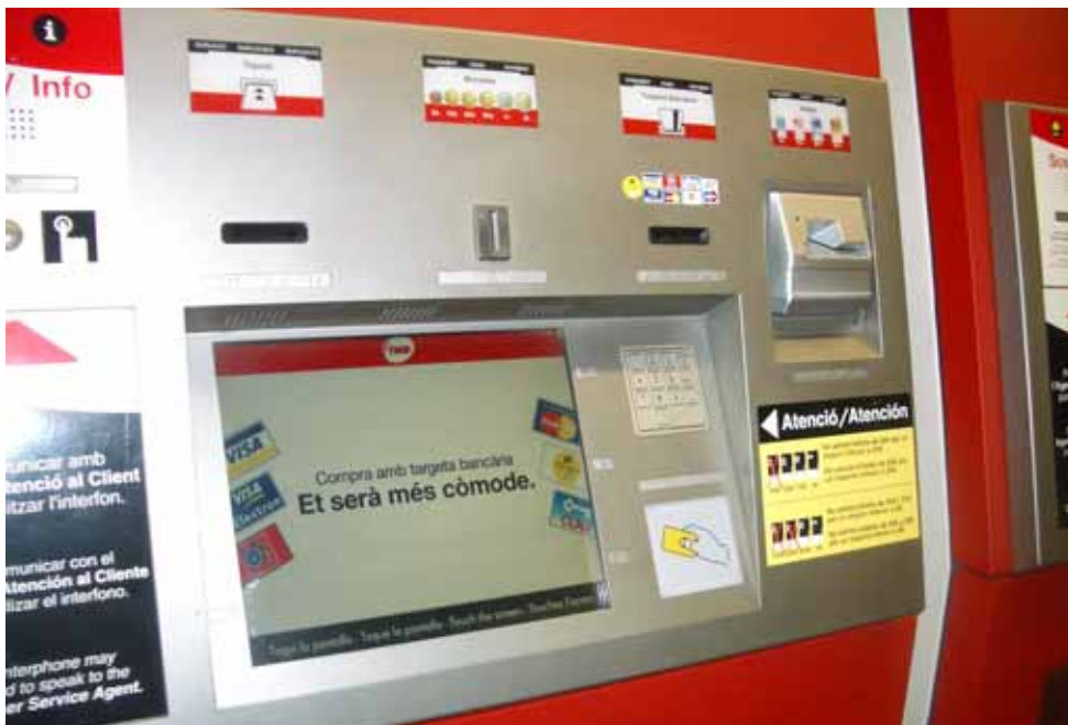
Bilde 79 Automat Barcelona. Skjermen har ramme med punktskrift og taleinformasjon. Maskinene har et navigasjonssystem som ved hjelp av punktskrift og talemeldinger leder kunder med synshemninger gjennom prosessen med å kjøpe billett.
