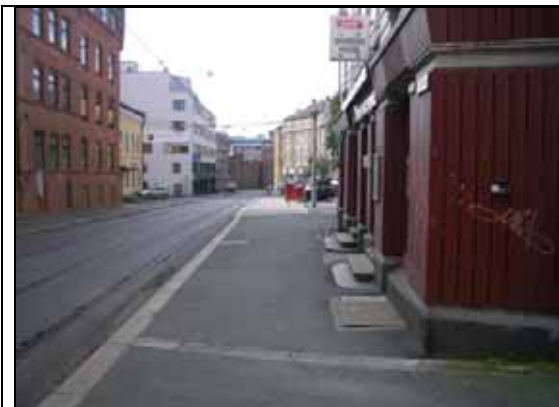
Bilde 26 Pilestredet, Oslo. En vanlig situasjon med trappeutspring og lave kanter inne ved veggen som kan gi snublefare. Her burde det ha vært en veggzone. Vannrennen i forgrunnen er et eksempel på en løsning som gir god brukbarhet for alle.
