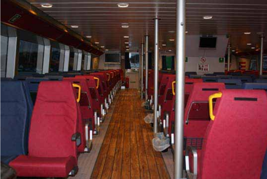
Bilde 16, Interiør Fjordkatt, hurtigbåt i trafikk for Rogaland Kollektivtrafikk FKF Kolumbus. Setetrekk er i pustende kunstskinn. Dette gir lettere renhold samtidig som parfyme og lignende ikke setter seg i stoffet og skaper problemer for allergikere.
