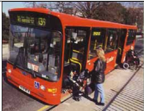
Bilde 76 London, Storbritannia. Elektrisk rampe på bakdør.
