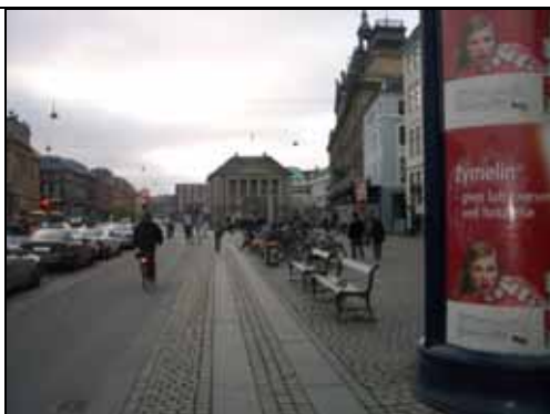
Bilde 3 , København. Slette stein til å gå på (og trille på) og hvilebenker gir gode forhold for fotgjengere. Denne bruken av slett stein gir også et ryddig gatebilde som tydelig viser hvor det er ment at en skal gå (og hvor en ikke skal plassere reklame), og gir samtidig en taktil og visuell støtte for synshemmede.
