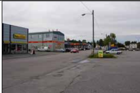
Bilde 11 Skippergata, Porsgrunn. Eksempel på utflytende, gatemiljø med store parkeringsarealer. Slike har ofte store asfaltflater med en blanding av biltrafikk, gående og parkering, der overgangene er uklare. Fortauet er usammenhengende med mange kryssende avkjøringer uten ledelinjer.
