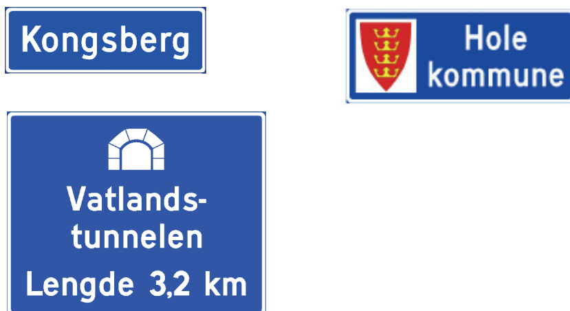
Figur 4-3.32 Eksempler på utforming av skilt 727 "Stedsnavnskilte"
