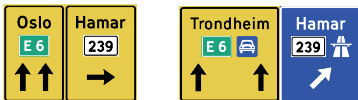
Figur 4-3.24 Eksempler på utforming av skilt 717 "Kjørefeltvegviser"
