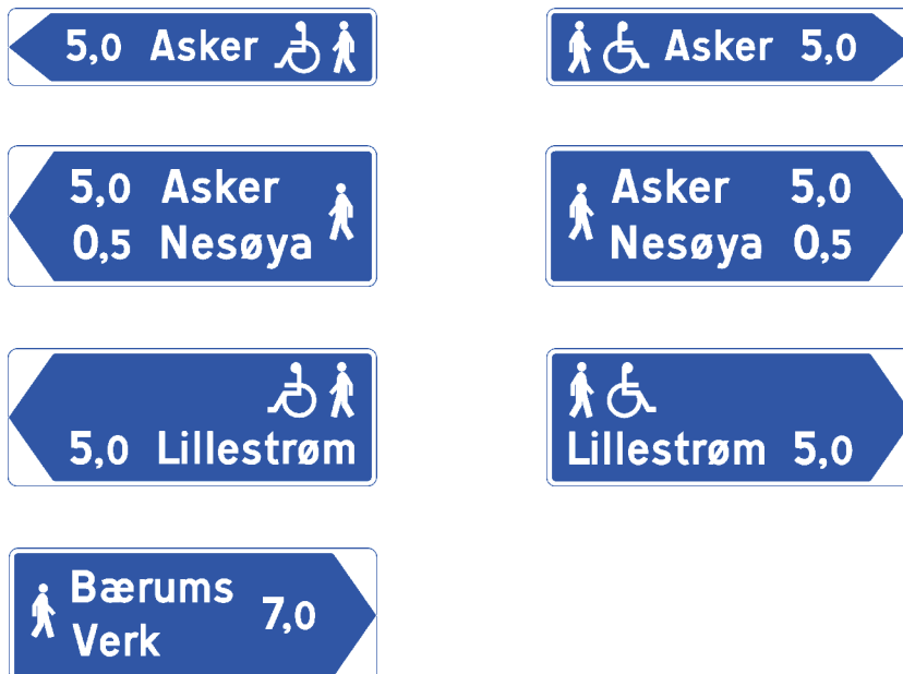
Figur 4-3.35 Eksempler på utforming av skilt 749 "Vegviser for gangtrafikk"
