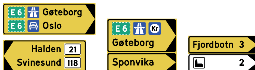
Figur 4-3.20 Eksempler på utforming av skilt 713 "Vanlig vegviser"
