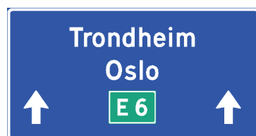
Figur 4-3.26 Utforming av skilt 719.2 "Portalvegviser for flere kjørefelt"
