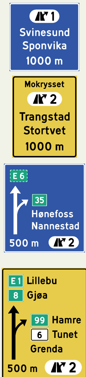
Figur 4-3.5 Eksempler på utforming av skilt 705 "Avkjøringstavle"
