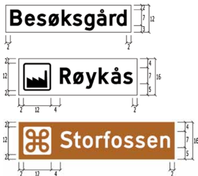
Figur 4-4.11 Plassering av symboler og tekst på felt med avvikende farge. Mål i syvdeler av H
