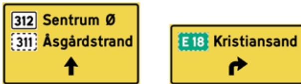
Figur 4-4.26 Eksempler på portalorienteringstavle 709.12
