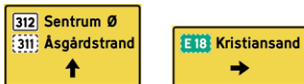
Figur 4-4.41 Eksempler på portalvegviser 719.12
