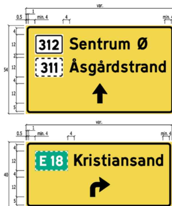
Figur 4-4.27 Eksempler på utforming av skilt 709.12
