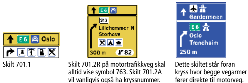
Figur 4-3.1 Eksempler på utforming av skilt 701 "Tabellorienteringstavle"
