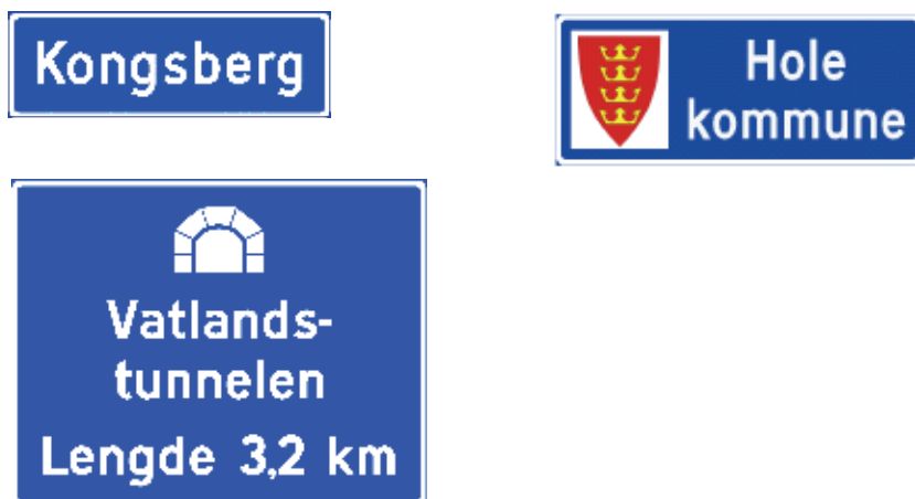
Figur 4-3.32 Eksempler på utforming av skilt 727 "Stedsnavnskilte"
