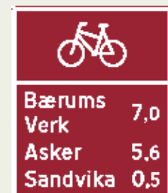
Figur 4-3.39 Eksempel på utforming av skilt 757 "Avstandsskilt for sykkelrute"
