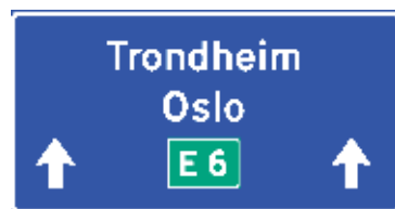
Figur 4-3.26 Utforming av skilt 719.2 "Portalvegviser for flere kjørefelt"
