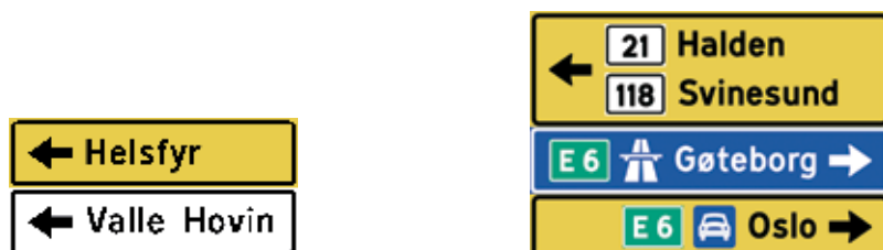
Figur 4-3.17 Eksempler på utforming av skilt 711 "Tabellvegviser"
