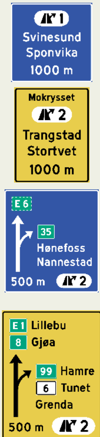
Figur 4-3.5 Eksempler på utforming av skilt 705 "Avkjøringstavle"
