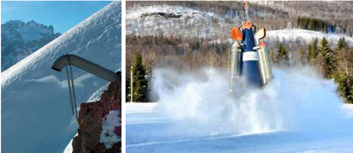
Figur 8.38 Foto av tårn for Gazex og av «gassklokke» for Daisy-Bell.
