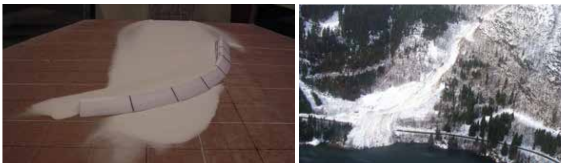
Figur 8.26 Modellforsøk med buet voll med helling 60°, venstre bilde. Den fremre bølgefronten har passert vollen, mens vollen har styrt de bakre massene tilfredsstillende. (Brateng 2005). Det høyre bildet viser vegstenging ved rv. 13 Sandvikskreda, fig 8.21, hvor det er de bakre skredmassene som har passert i nedre ende av vollen. Foto: S.H. Frækaland
