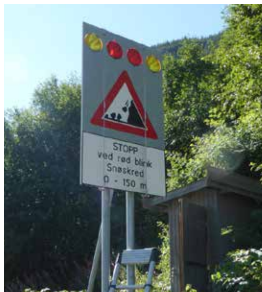
Figur 8.37 Geofoner kan brukes til å registrere skred som er i bevegelse. Trafikantene blir varslet om skredet ved hjelp av lys- og lydsignaler. Foto H. Bjordal
